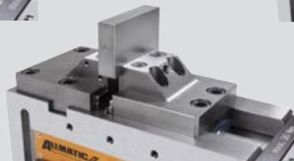
Spannung vorbearbeiteter Werkstücke
