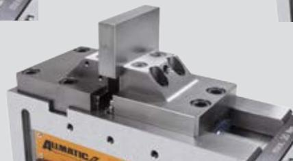
Spannung vorbearbeiteter Werkstücke
