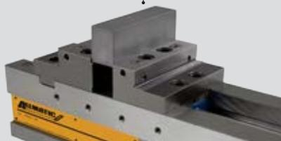
**Spannung vorbearbeiteter Werkstücke**
