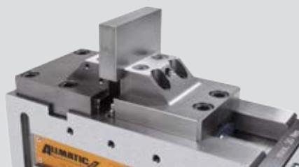
Spannung vorbearbeiteter Werkstücke
