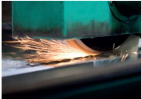
3. Vollautomatischer Schleifprozess für Profilschleifen
