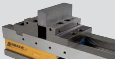
Spannung vorbearbeiteter Werkstücke
