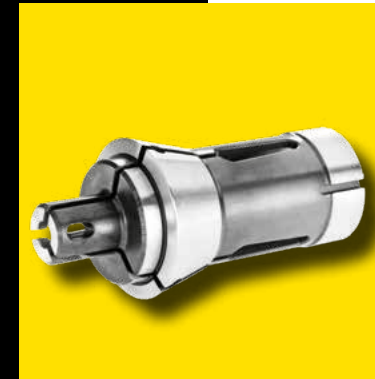
Spezielle Vorbauspannzange mit Aussparung zum prozesssicheren Anbringen von Langlöchern. Vorbau gerade, jedoch schmaler geformt. Vorbau abgesetzt für bessere Zugänglichkeit der Werkzeuge.
