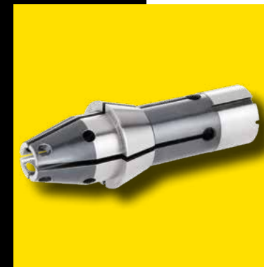
Konische Sonderspannzange mit Bohrung Diese Vorbauspannzange ermöglicht es Ihnen, Ihr Werkstück im gespannten Zustand durch den Vorbau hindurch zu bearbeiten. Es sind verschiedene auf das Bauteil abgestimmte Aussparungen möglich.
