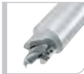
Kombinationswerkzeug mit Bohrgewindefräser M 16 x 1,5 stirnschneidig und einer PKD bestückten Konturplatte zur Bearbeitung einer vorgegossenen Bohrung
