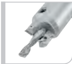
Kombinationswerkzeug mit Bohrgewindefräser M 12 2,5xD, IK Plansen- und Anfasplatte
